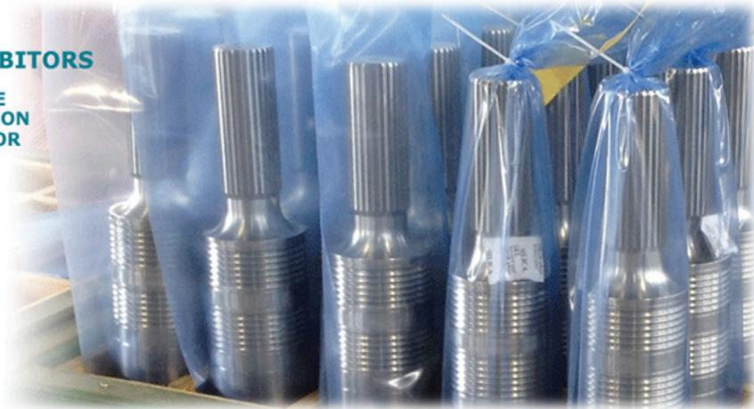
Exemple d'emballage anticorrosion VCI : Sacs VCI + desséchants
